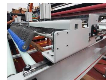
Sistema presor de ruedas ajustables con elevación neumática programable
